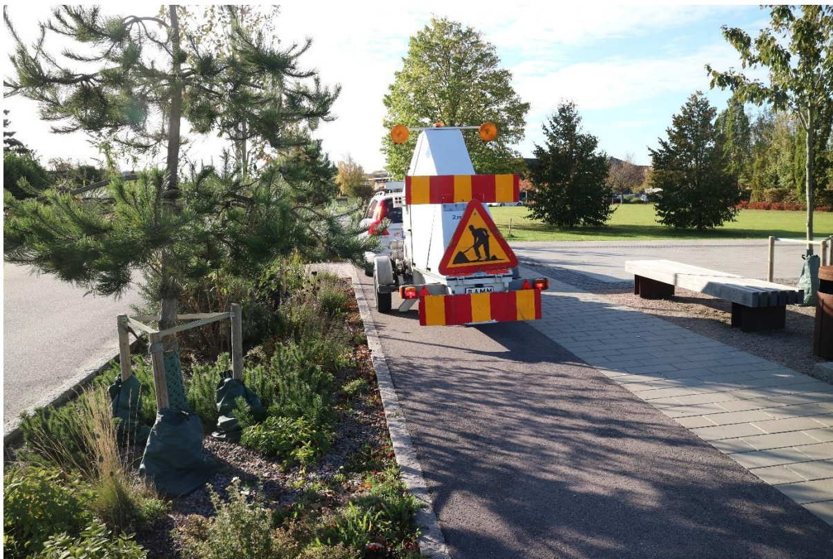
Figur 4-17. Fallviktsmätning på cykelväg med öppet förstärkningslager i anslutning till växtbädd.
