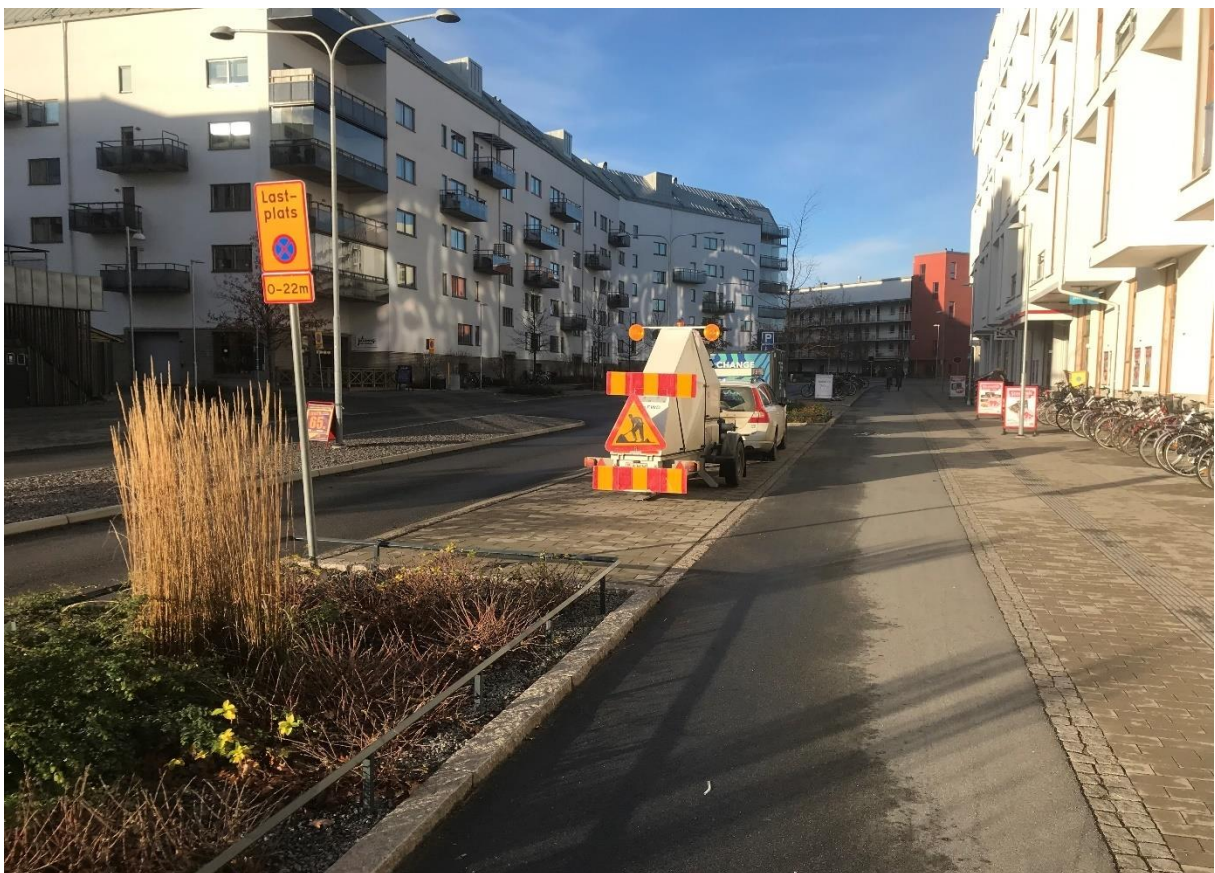
Figur 4-7. Fallviktsmätning Rosendal etapp 1, Uppsala på Torgny Segerstedts allé
