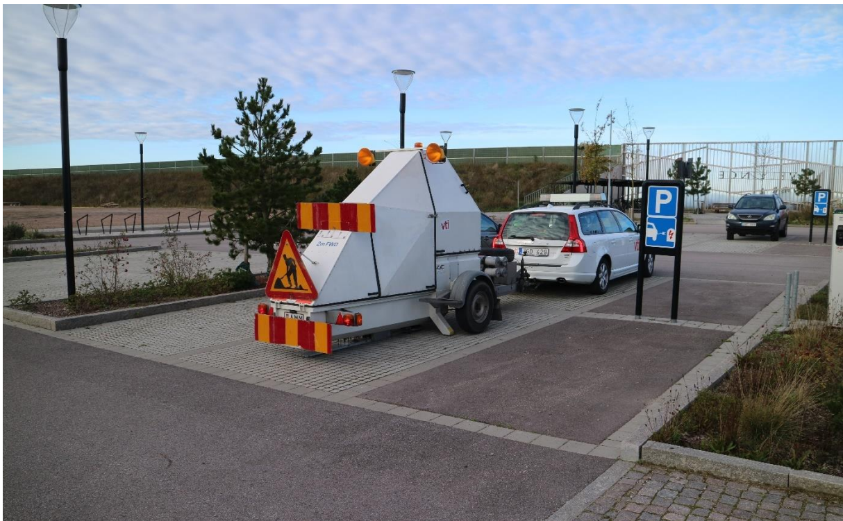
Figur 4-15. Fallviktsmätning på gräsarmerad parkeringsyta i Vellinge med fog av 2/5. Standard konstruktion med asfalt i anslutning till p-ytorna har använts som referens.
