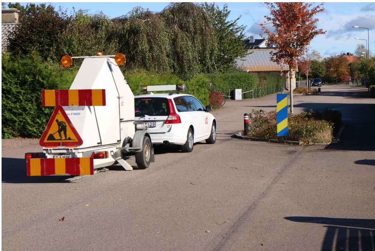
Figur 4-23. Fallviksmätning på standardkonstruktion i Munka Ljungby
