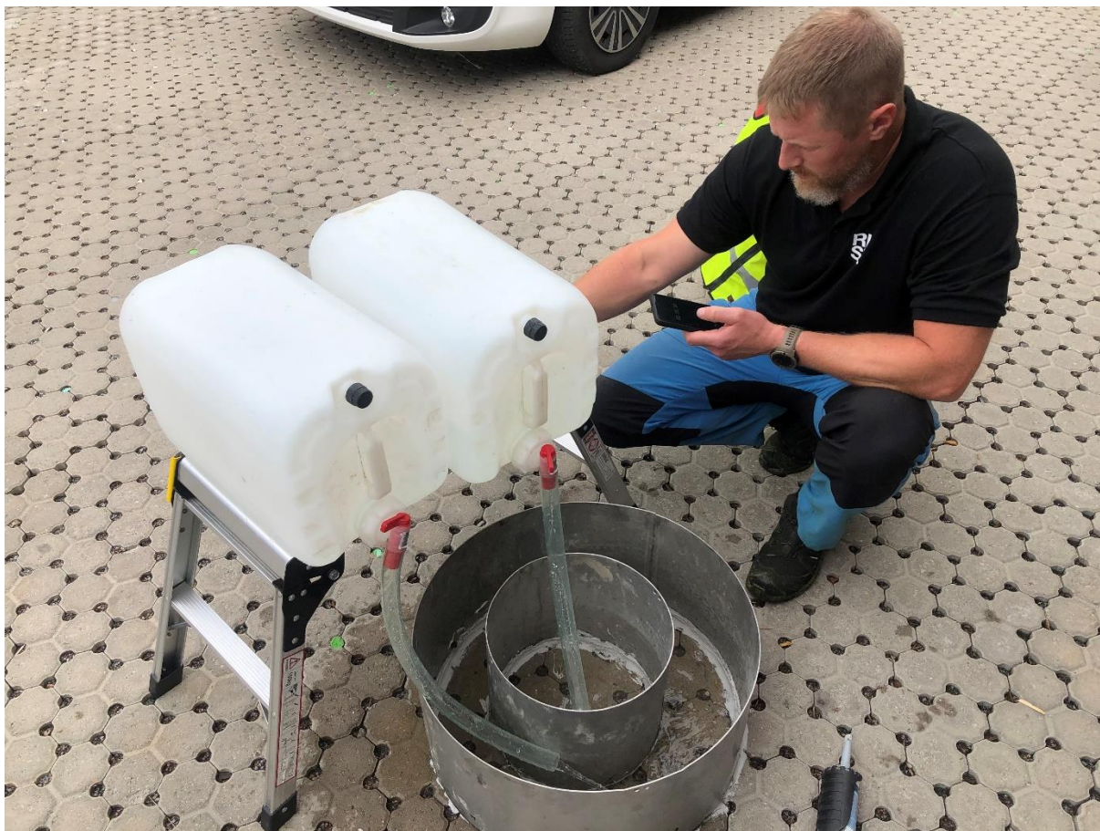
Figur 5-8 Infiltrationsmätning med dubbelringsinfiltrrometer.
