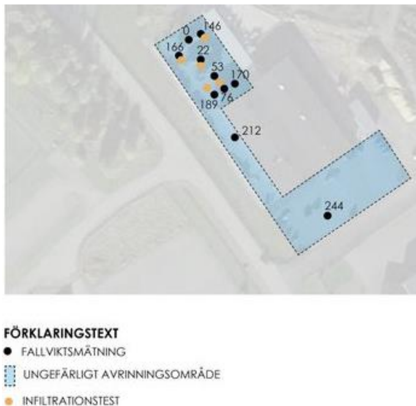
Figur 5-9 Mätpunkter för fallviktmätning och infiltration i Vara.
