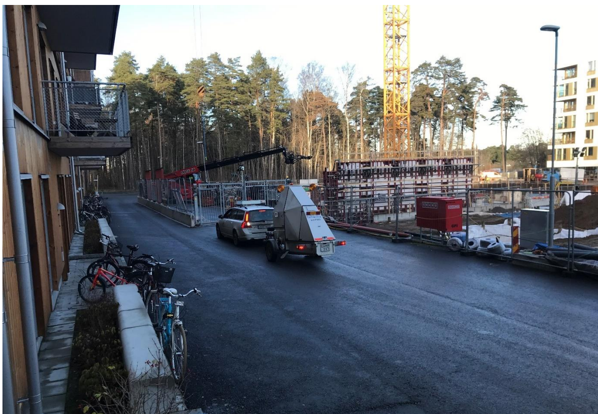
Figur 4-9. Fallviktsmätning på obundet bärlager i Rosendal etapp 2 på Dekangatan.
