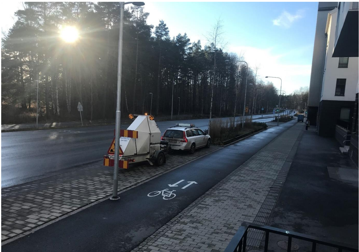
Figur 4-6. Fallviktsmätning Rosendal Etapp 1, Uppsala på Vårdsätravägen
