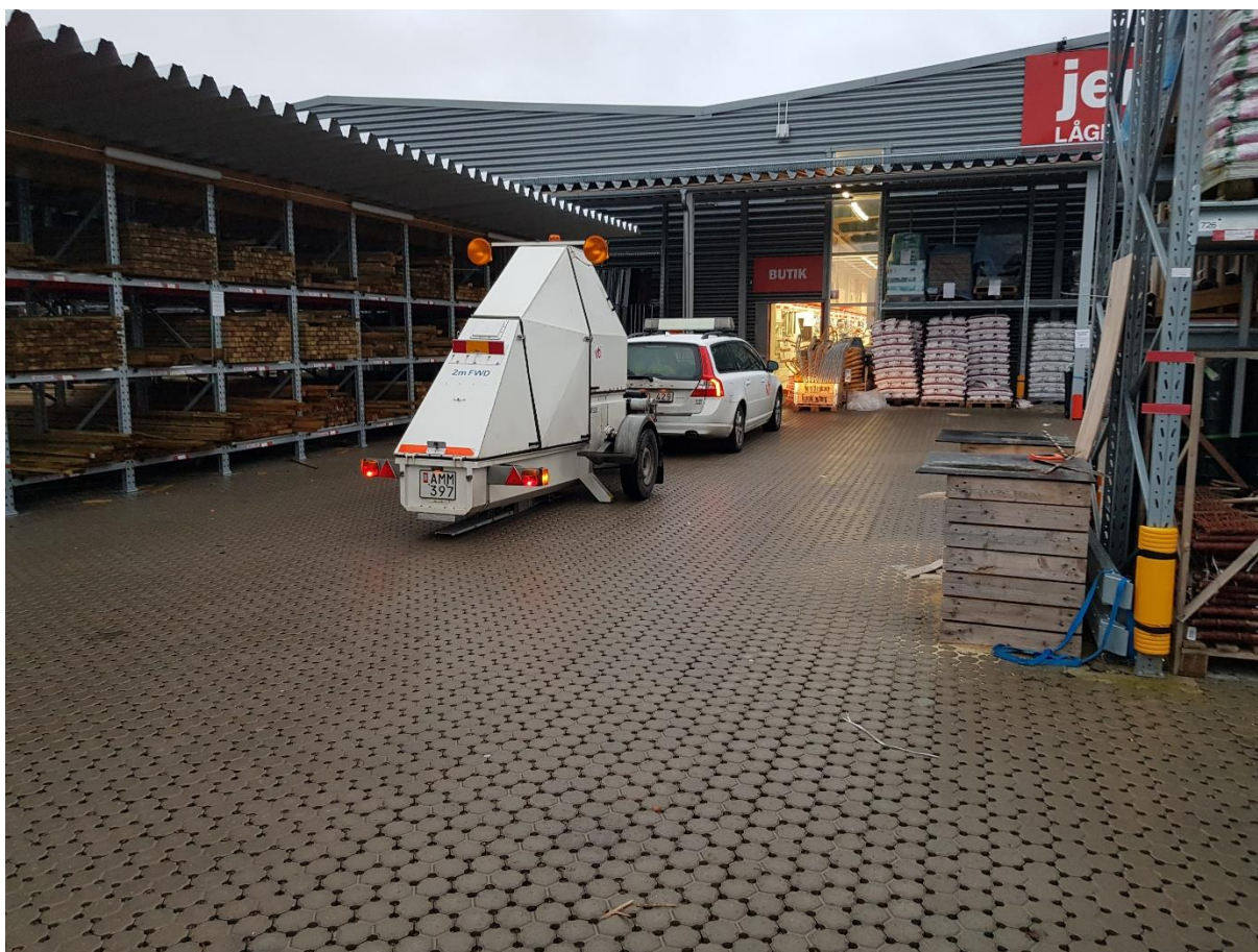
Figur 4-27. Fallviksmätning på dränerande markstensyta på Jem & Fix i Vara
