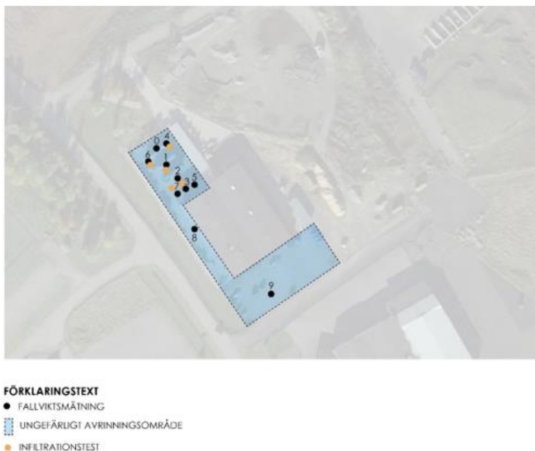
Figur 52. Översiktspild över projektområdet med öppet förstärkningslager och dränerande beläggning med redovisning av platser för fallviktsmätning, Jem & Fix i Vara.
