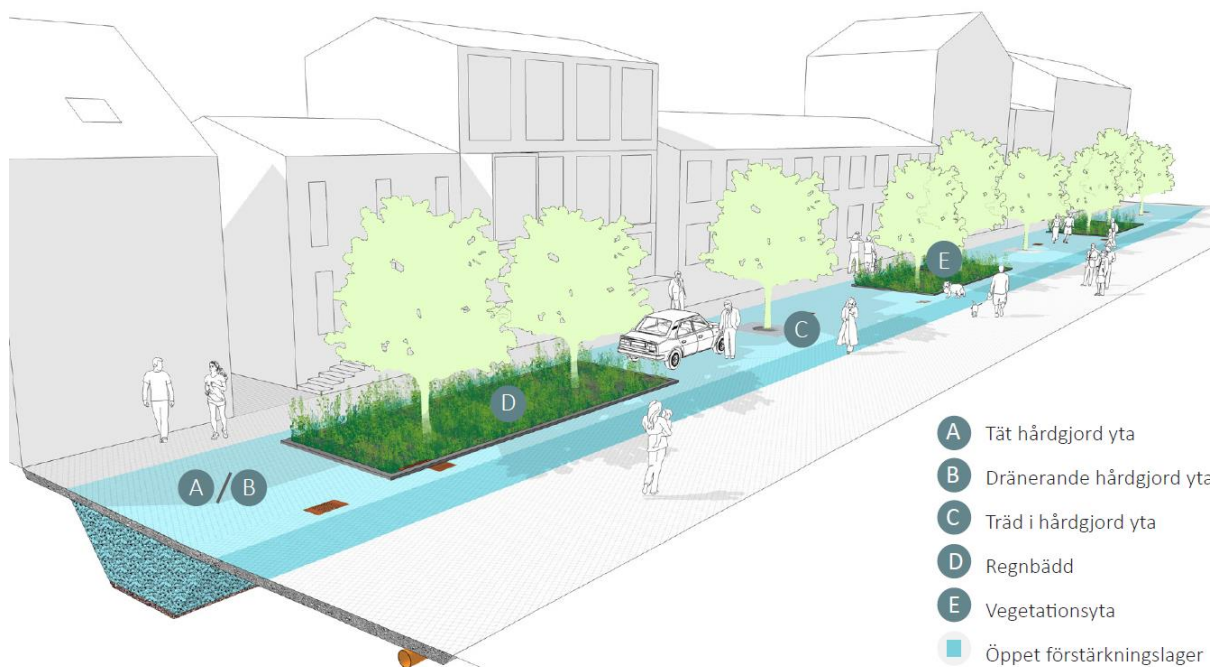
Figur 1. Exempel på gata med BGG-system förlagd i flexzon. Det blå området symboliserar ett öppet förstärkningslager som här ligger i ett långsträckt stråk utmed hela gatan. På markytan kan hårdgjorda ytor varvas med regnbäddar, vegetationsytor och träd på valfritt sätt. Denna princip ger stora möjligheter till hantering av dagvatten samtidigt som stadsrummet kan utformas flexibelt och framtida ändringar av markkonstruktioner underlättas (Edge).
