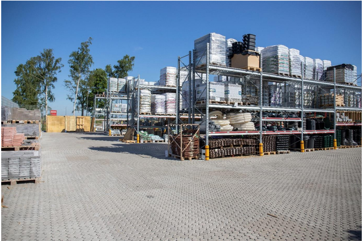
Figur 54. Jem & Fix, Vara. Stapling på höjden kräver lågt eller inget fall på ytan.
